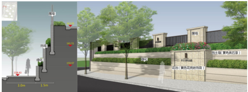
台阶式绿化削弱挡土墙视觉高度
