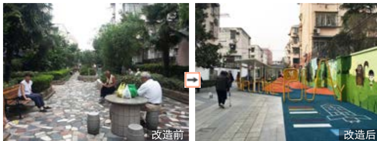
拆除花坛、整理两侧绿带，将中间带状空间分成通行和休闲两部分，休闲带设置有遮荫廊架、儿童活动场地、健身器材和休憩桌椅，提高空间使用的复合化
