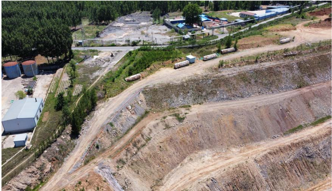
照片 2-5 矿区开采过程中形成的边坡
