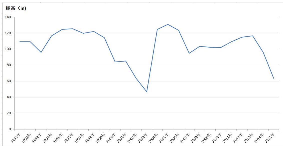
图 3-2 港 15 号孔多年度水位动态曲线
